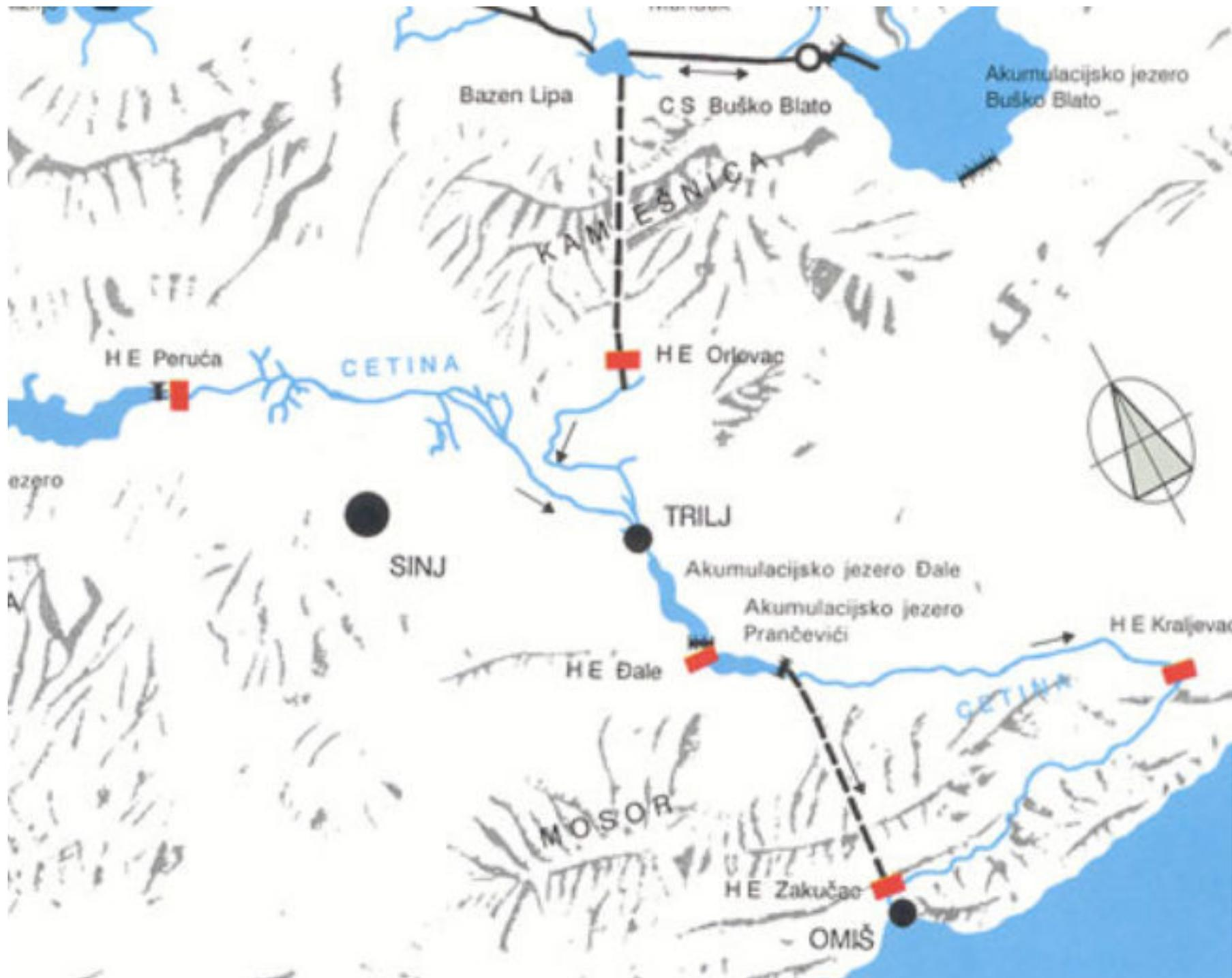
**HE Orlovac** je derivacijska hidroelektrana koja vodu dobiva iz kompenzacijskog bazena Lipa, povezanog reverzibilnim kanalom s akumulacijom Buško blato.
